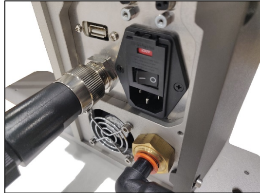
Figure 7. Raccordement de la pompe à air à l'arrière de la machine.
